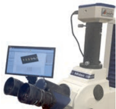
Invention Digital Kamera (63AAA058) mit 0.5x C-Mount Adapter(63AAA067) für digitale Betrachtung
