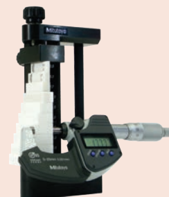
Endmaßhalter 516-607 anwendbare Endmaßsätze 516-156, 516-157, 516-158
