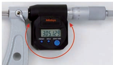
Die Anzeige ist 330° drehbar
