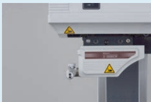
Detektorhalter S-3000 CR (optional) oben/unten und 90° schwenkbar (Querabtastrfunktion)
