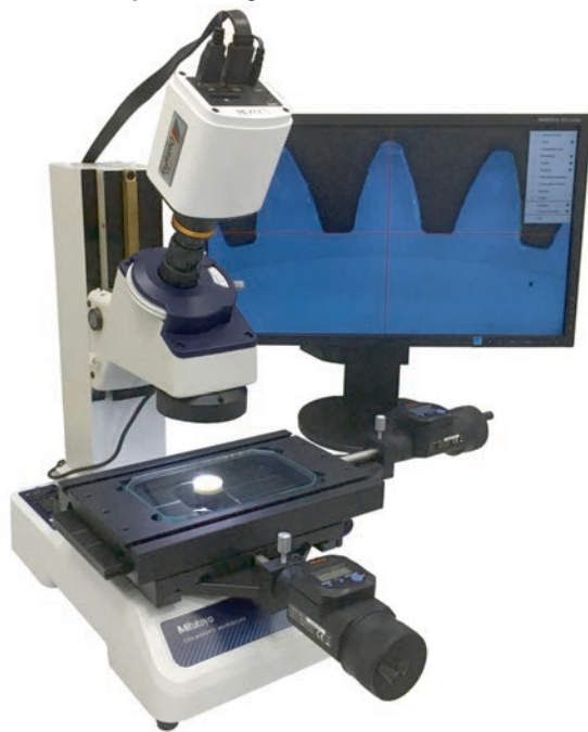
TM-1005B mit optionalem LED Ringlicht(63AAA001), 0,37x Okularadapter (63AAA060) und digital HDMI Kamera (63AAA059)
