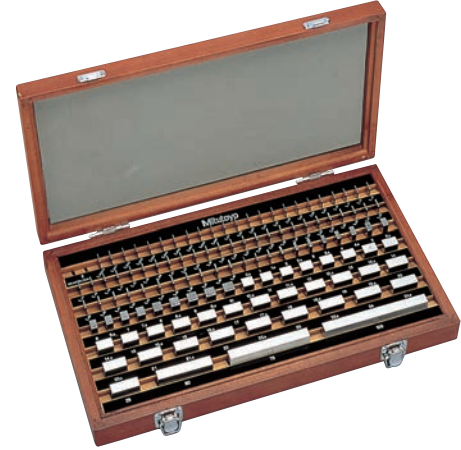
Parallelendmaß-Satz, Stahl, 103-teilig
