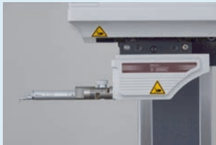
Detektorhalter S-3000 C (optional) 90° schwenkbar (Querabtastrfunktion)
