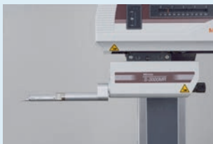
Detektorhalter S-3000 MR (optional) oben/unten schwenkbar
