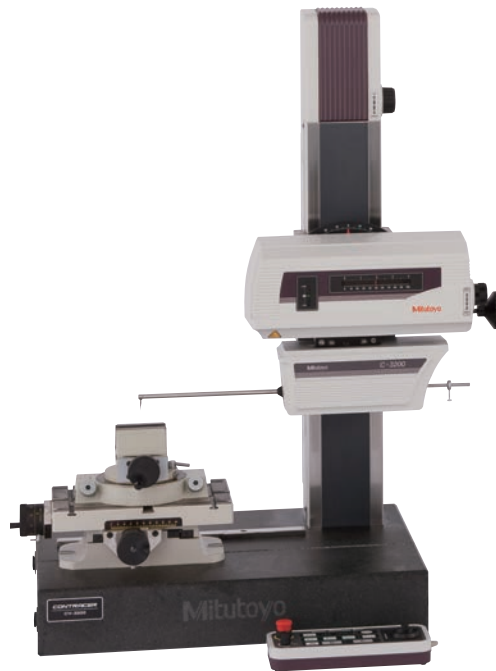
Contracer CV-3200 (CV-4500 ist ausgestattet mit Doppeltastspitze)
