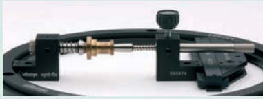
Klemmung eines zylindrischen Werkstücks zwischen Zentrierspitzen.
