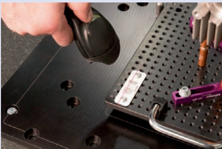
Start eines Teileprogramms mittels Barcode
