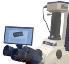
Invenio Digital Kamera (63AAA058) mit 0.5x C-Mount Adapter (63AAA067) für digitale Betrachtung
