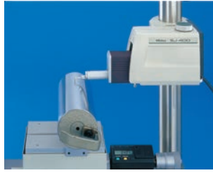
Messung einer zylindrischen Oberfläche, radial
