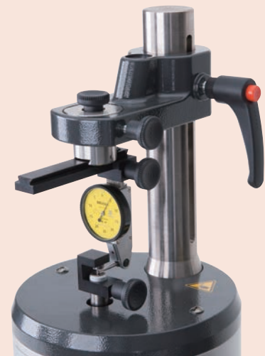
Kalibrierung von Fühlhebelmessgerät mit optionalem Zubehör
