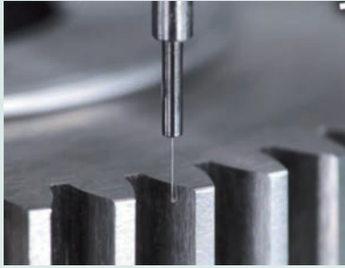
MPP-NANO Zahnradmessung mit Module 0,8
