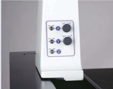
Ein-Hand-Fixierung der Achsen und zentrale Feinjustierung für die einfache Positionierung.
