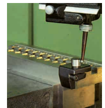
Beim Positionieren der Arbeitsspindelachse an der Werkzeugkante
